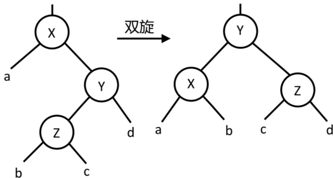
如上图，考虑一次双旋，设  $X, Y$  旋转前平衡度为  $\rho_1, \rho_2, \rho_3$ ，旋转后为  $\gamma_1, \gamma_2, \gamma_3$ 。
