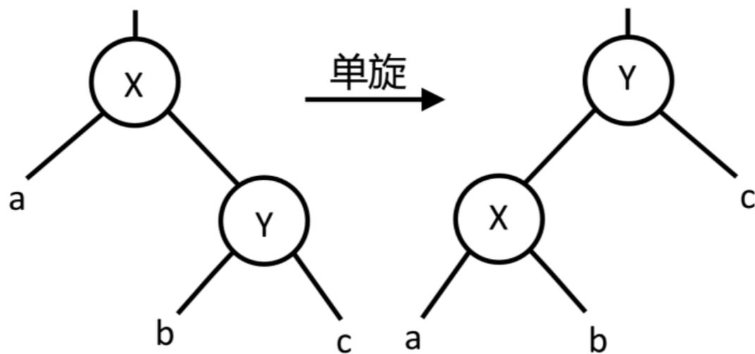
如上图，考虑一次单旋，设  $X, Y$  旋转前平衡度为  $\rho_1, \rho_2$ ，旋转后为  $\gamma_1, \gamma_2$ 。
